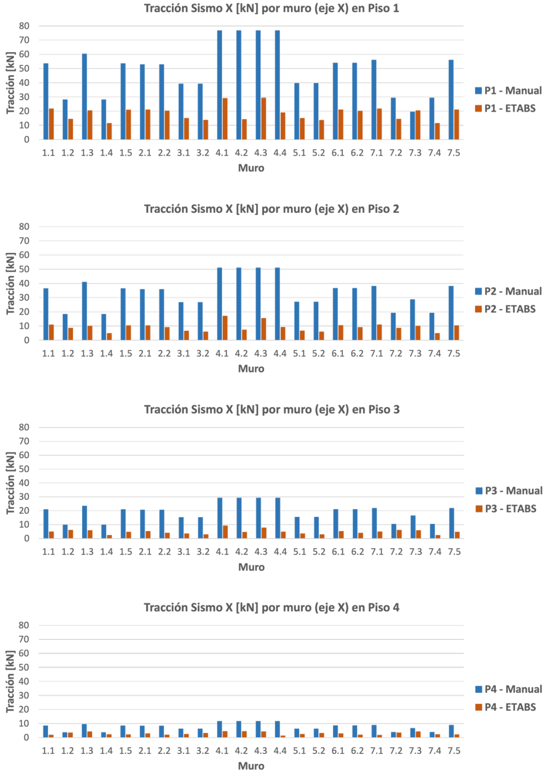
Figura 35: Distribución de tracción por muro por piso debido a Sismo X en eje X
