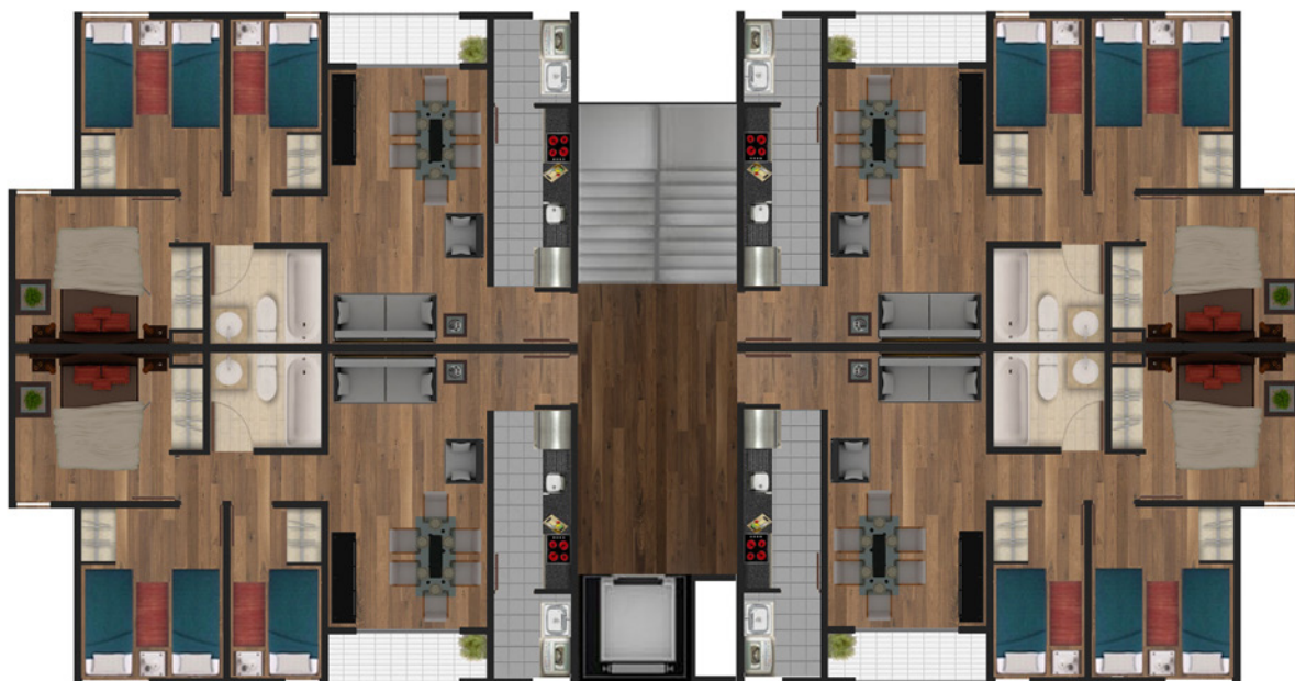
Figura 14: Planta arquitectónica del edificio Tipo A
