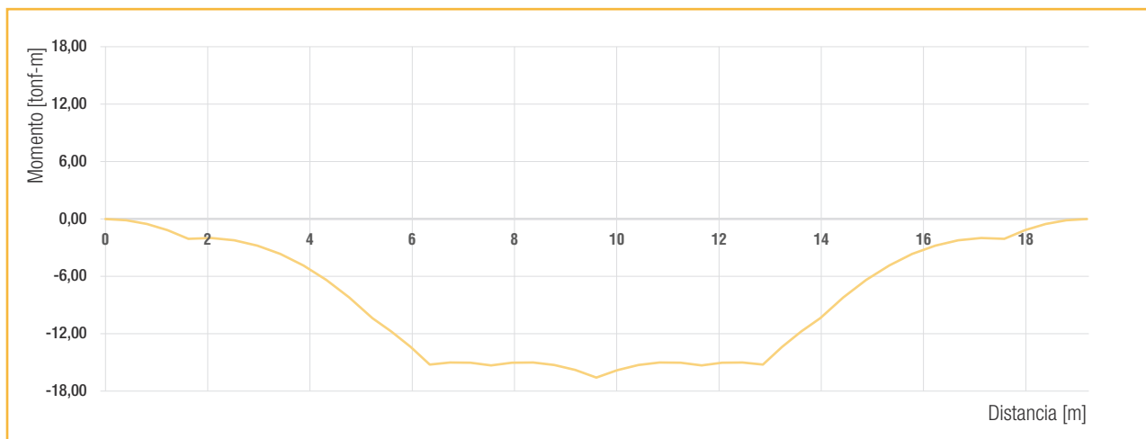
Figura 64: Diagrama de momento de la losa de entrepiso en dirección Y-Y del edificio Tipo B
