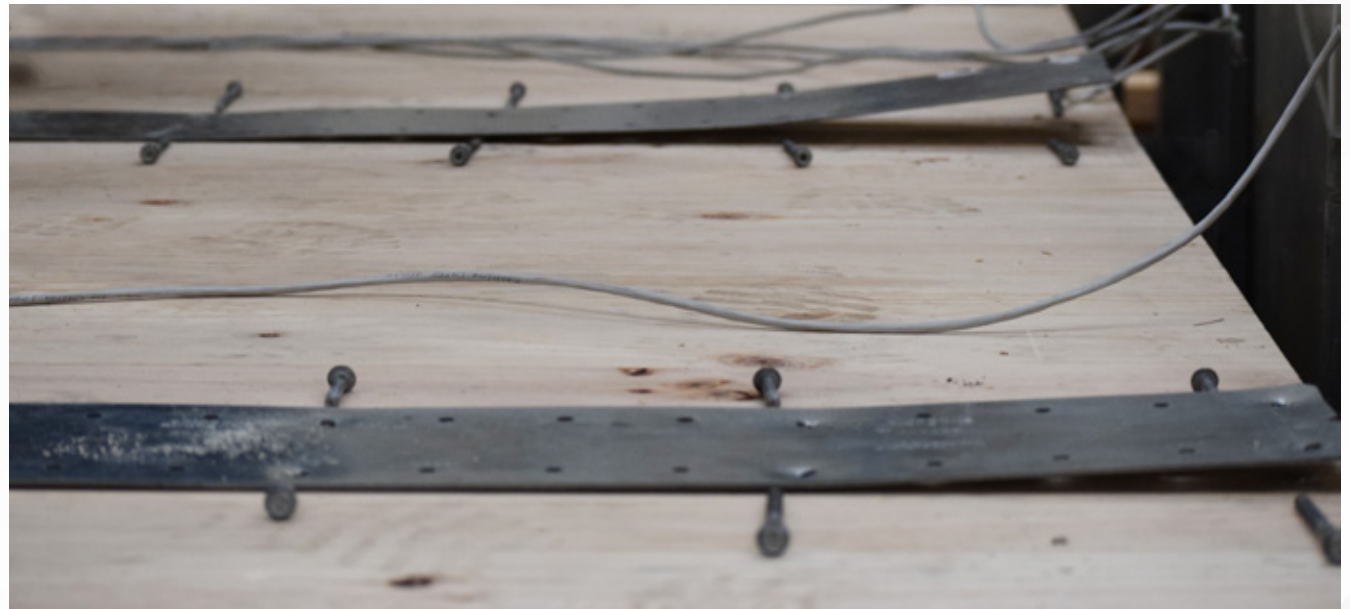
Resultados de ensayo de resistencia a carga lateral, con falla en medios de unión. Imagen: CIM UC
