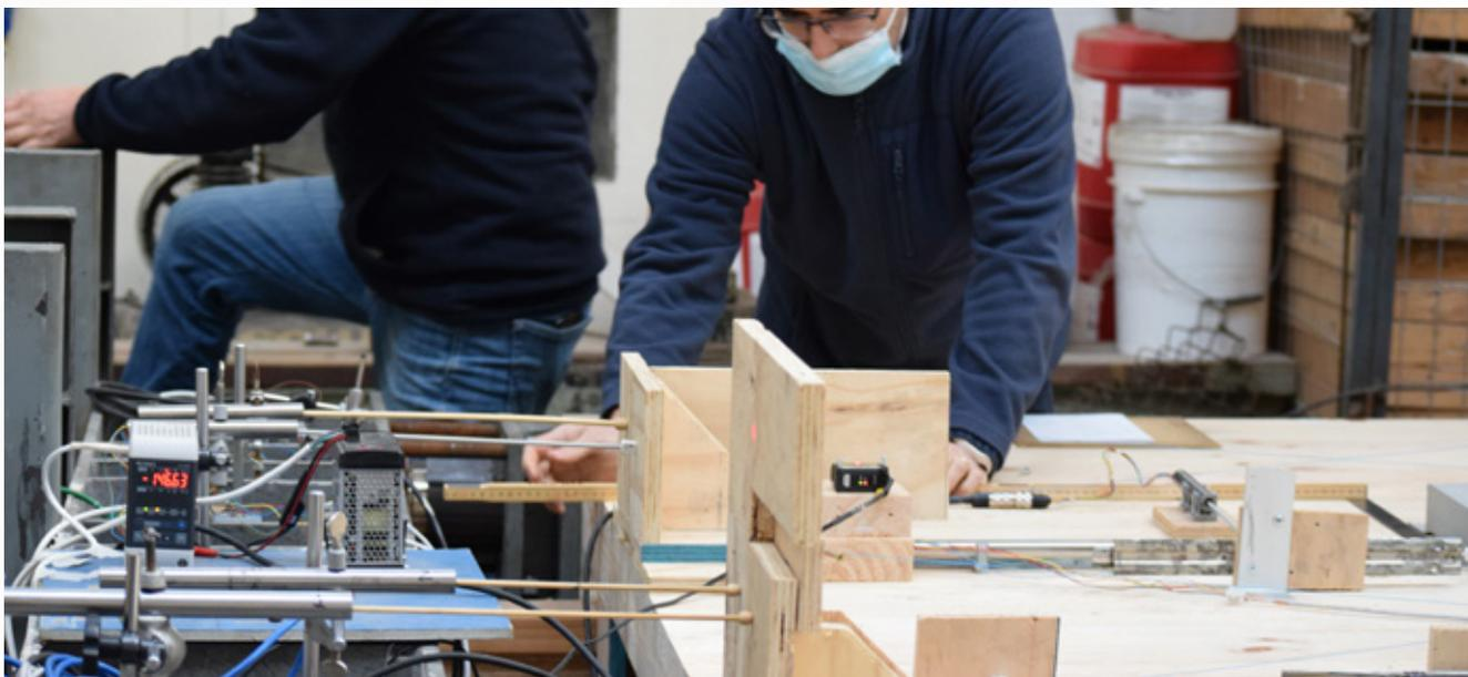
Ensayo de resistencia de carga lateral en madera CLT. Fuente: elaboración propia
