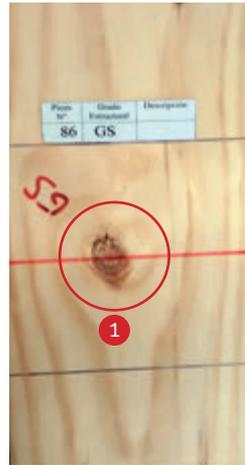
■ Probeta de Pino Radiata con grado estructural visible: **Pieza con 1 nudo grado G5**
