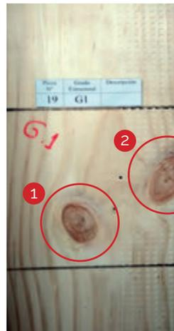
■ Probeta de Pino Radiata con grado estructural visible: **Pieza con 2 nudos grado G1**
