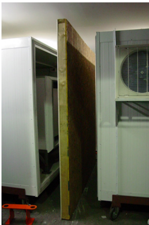
Figura 9: Fotografía de ensayo en laboratorio para medir transmitancia térmica de un muro.
