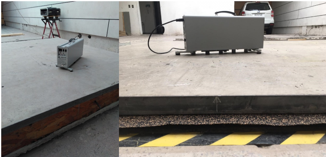
Figura 24: Ensayo de impacto de una solución de entepiso realizado en laboratorio acústico CPIA (fuente CPIA).
