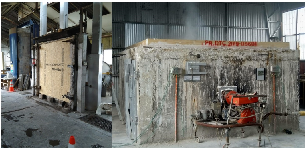
Figura 15: Laboratorio IDIEM. Ensayo de probetas de soluciones constructivas de horno horizontal y vertical.
