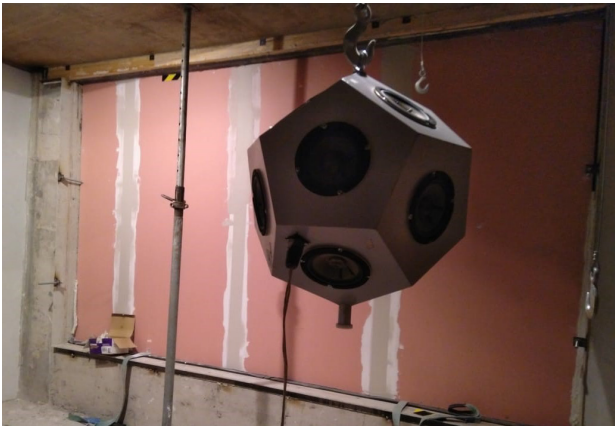
Figura 22: Ensayo aéreo de un muro divisorio realizado en laboratorio acústico CPIA.
